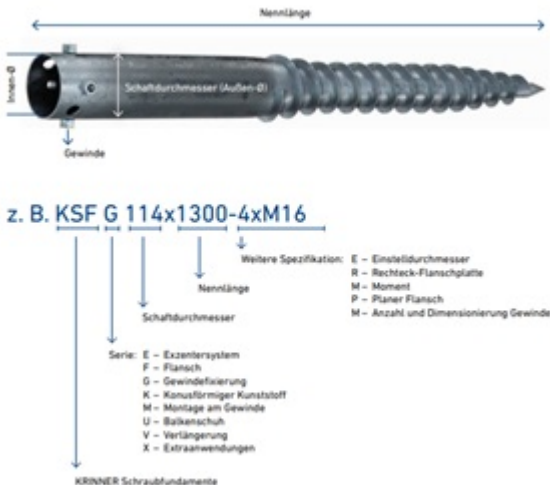
Abbildung 1: Alle Krinner Schraubfundament bestehen komplett aus Stahl und sind feuerverzinkt.
