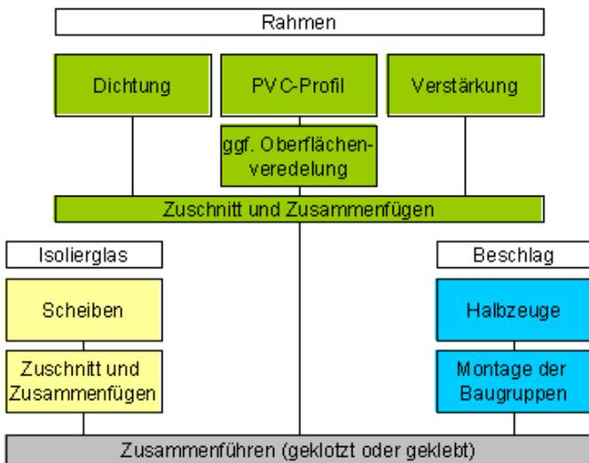
Abb. 2-1: Schematische Darstellung der Herstellung einer Fenstereinheit
