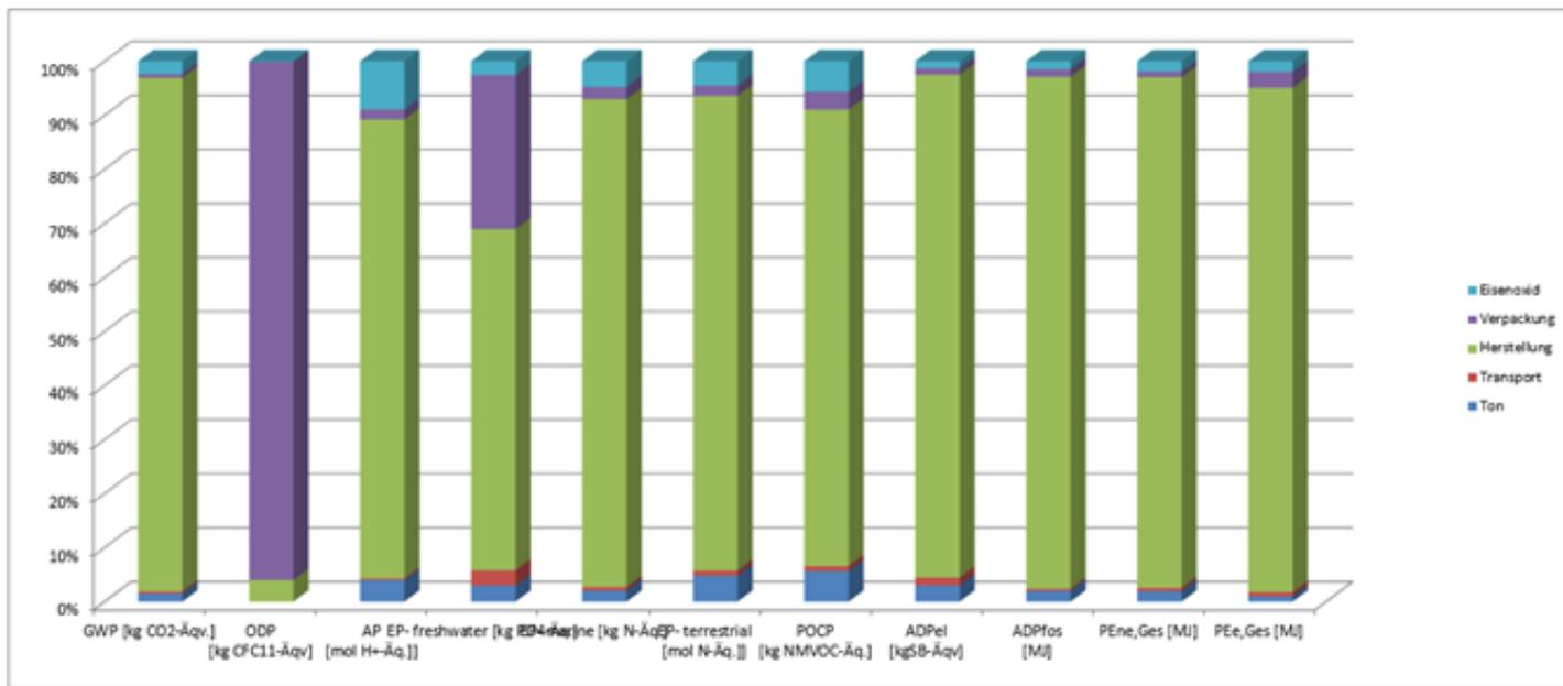
Die Auswertung der ökobilanziellen Ergebnisse der Riemchen zeigt auf, dass die Umweltwirkungen in allen Umweltkategorien speziell vom Energieverbrauch während des Herstellungsprozesses (Strom und speziell von der thermischen Energie aus Erdgas) im Werk beeinflusst werden. Die Verpackung, der Transport, der eingesetzte Ton und das Eisenoxid nehmen nur eine sehr untergeordnete bis marginale Rolle ein.
