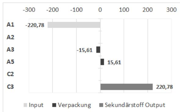
**Abb. 2: Holzimmanente CO<sub>2</sub>-Produktsystemein- und -ausgänge. Die inverse Vorzeichengebung der In- und Outputs trägt der ökobilanziellen CO<sub>2</sub>-Flussbetrachtung aus Sicht der Atmosphäre Rechnung.**
